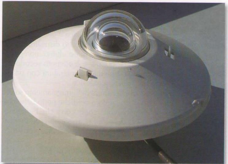
▲ Figura 1: Esempio di solarimetro a termopila o piranometro
