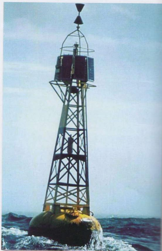
▲ **Figura 1:** Esempio di boa di segnalazione fotovoltaica (foto Photowatt)
