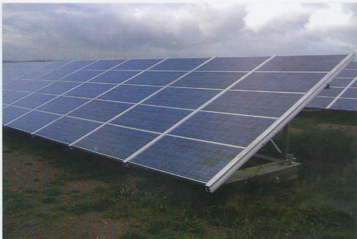
▼ **Figura 10:** Esempio di impianto fotovoltaico con sistema ad inseguimento solare su 2 assi (Morfasso – 20 kW)
