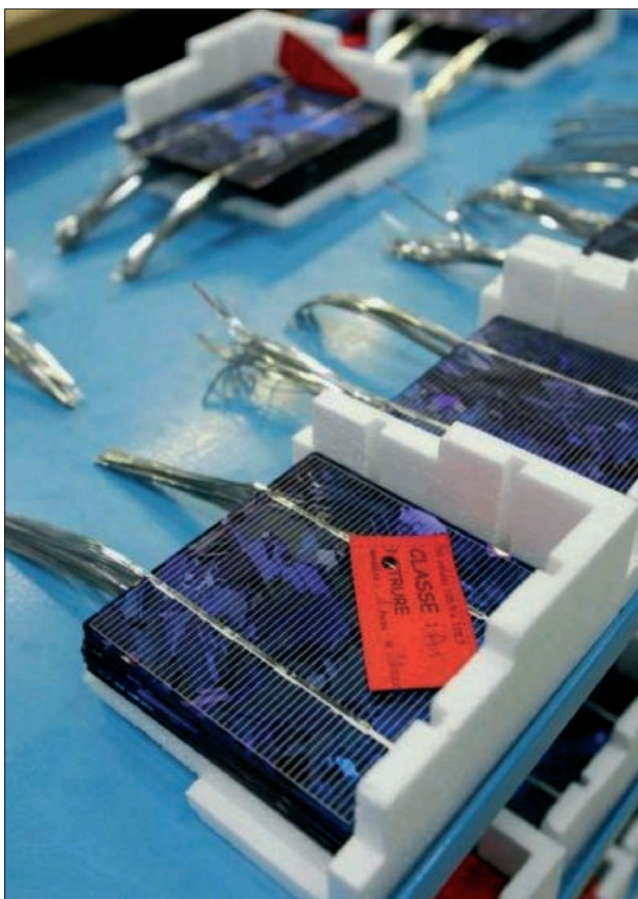
Figura 3 – Celle in silicio policristallino complete di terminazioni per il collegamento (Fonte EPIA)
