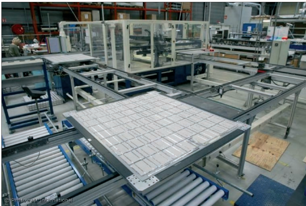
Figura 2 – Realizzazione di un modulo fotovoltaico. Si possono notare le celle uniformemente spaziate e disposte sul supporto costituito dal vetro anteriore (Fonte EPIA)
